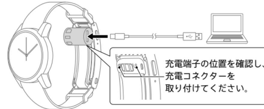
充電コネクタを取り外すときは、コネクタのUSB Type-C®端子の反対側にある▲(三角マーク)の部分をお指の腹で押し上げてください。
